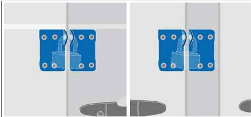
Abbildung 22: Beschläge für Vorhängeschloss, Hecktür (links), Laderaumschiebetür (rechts)
