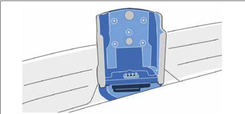
Abbildung 19: Scanner- / Monitorhalterung
