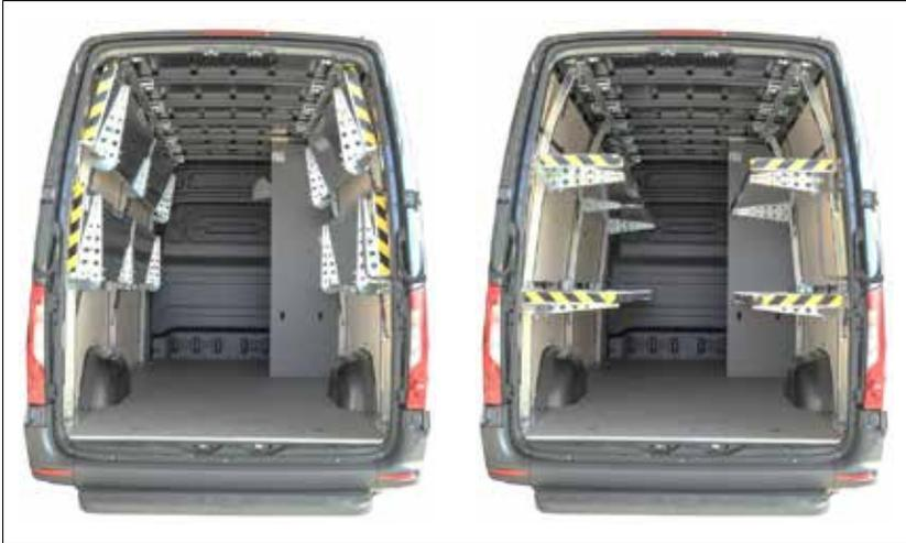
Abbildung 1: Regalsystem hochgeklappt (links), ausgeklappt (rechts)
