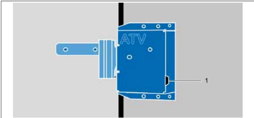
Abbildung 13: 1 Schließsystem an Laderaumtüren Fabrikat ATV, geschlossener Zustand
