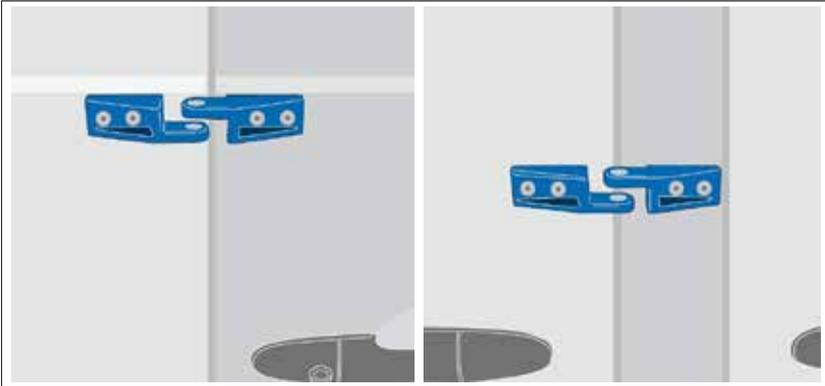
Abbildung 21: Beschläge – Zollsicherung außen, Hecktür (links), Laderaumschiebetür (rechts)
