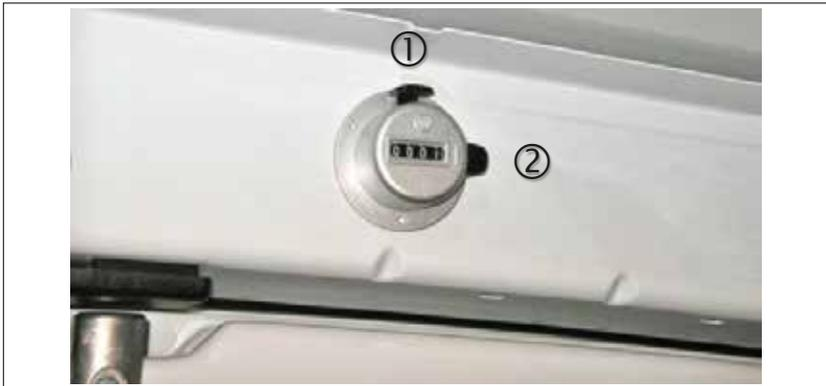
Figura 7: Contatore delle fermate
