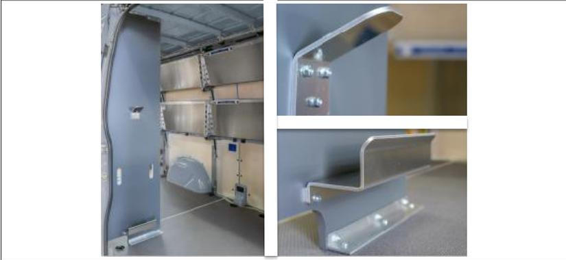
Figura 5: Sostegno per carrello portapacchi senza carrello (sinistra), dettaglio (destra)
