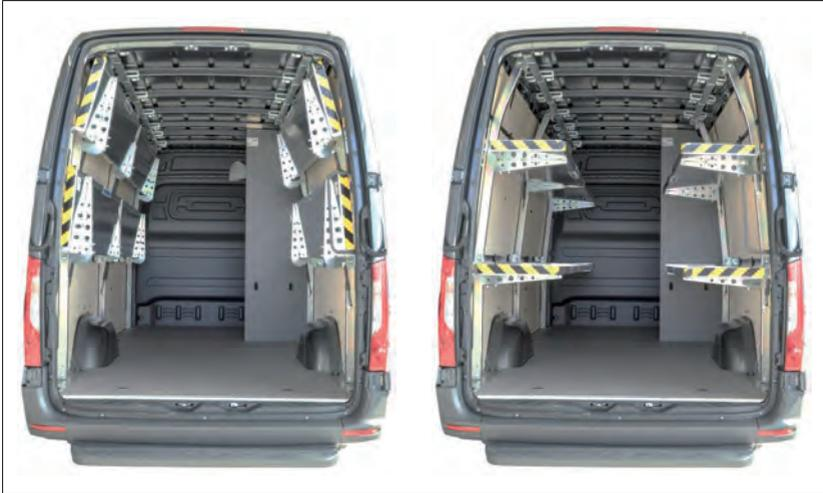
Abbildung 1: Regalsystem hochgeklappt (links), ausgeklappt (rechts)
