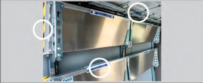
Abbildung 2: Regalsystem Detail, Positionen der Warnschilder
