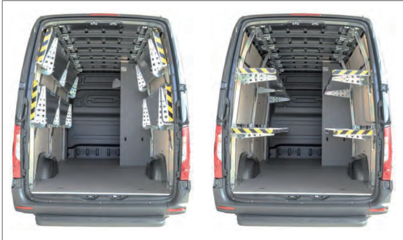
Figura 1: Sistema de estanterías plegado (izquierda), desplegado (derecha)
