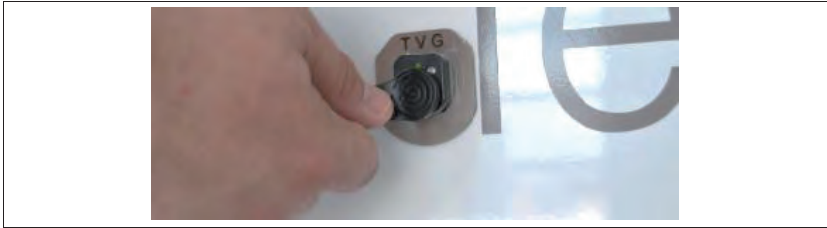
Figura 12: Sistema de cierre en puertas del compartimento de carga, marca TVG, apertura con llave Dallas
