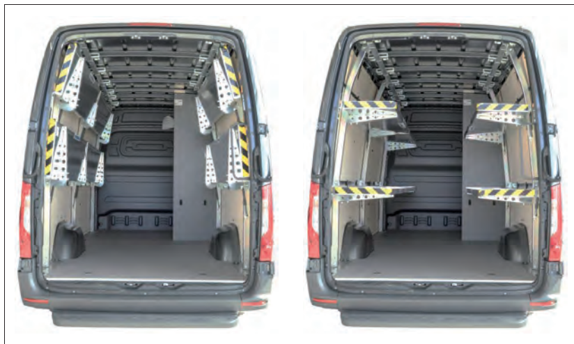
Illustration 1 : Système d'étagères replié (à gauche), déplié (à droite)
