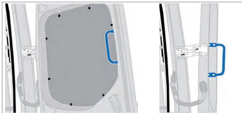
Figura 4: Maniglia – portellone destro, semi-aperto (sinistra), aperto (destra)
