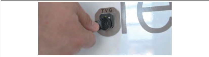
Figura 12: Sistema di chiusura sulle porte del vano di carico Prodotto TVG, aprire con una chiave Dallas
