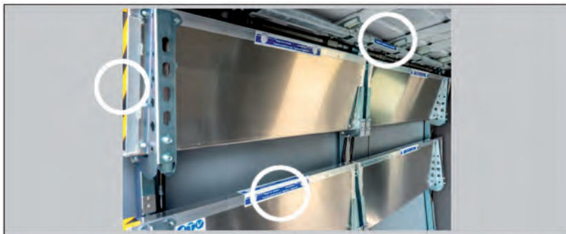
Figura 2: Scaffalatura dettaglio, posizioni dei segnali di avviso
