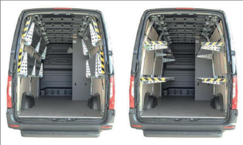
Abbildung 1: Regalsystem hochgeklappt (links), ausgeklappt (rechts)
