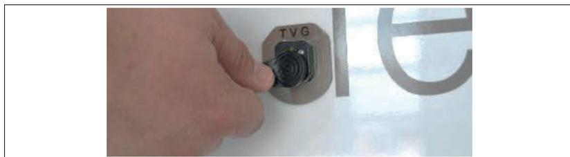
Abbildung 12: Schließsystem an Laderaumtüren Fabrikat TVG, Öffnen mit Dalles-Key
