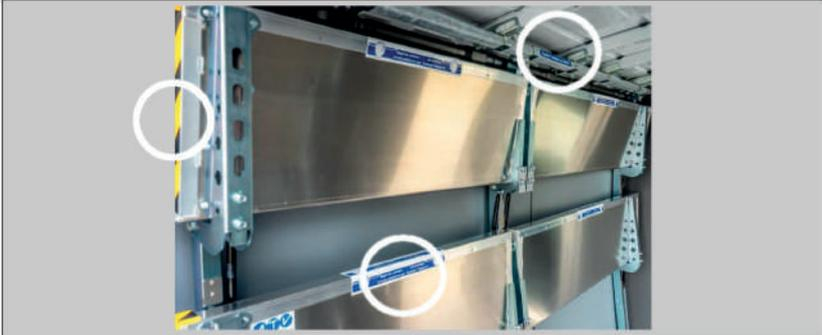
Abbildung 2: Regalsystem Detail, Positionen der Warnschilder
