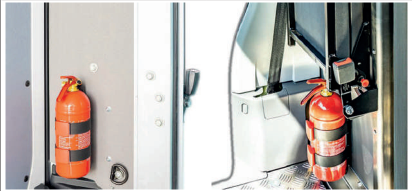
Figura 3: Extintor, en la puerta corredera del compartimento de carga (izquierda), en la cabina del conductor (derecha)
