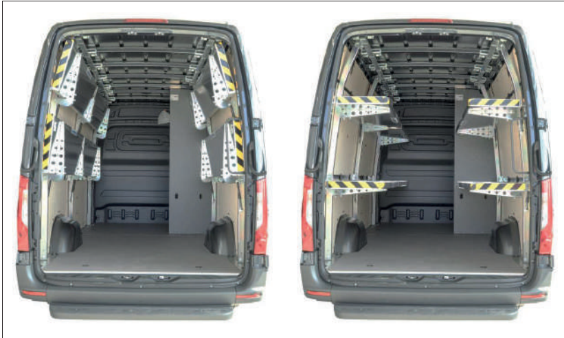
Figura 1: Sistema de estanterías plegado (izquierda), desplegado (derecha)
