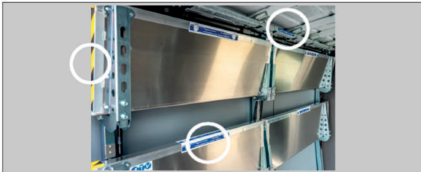
Figura 2: Detalle de sistema de estanterías, posición de los letreros de advertencia
