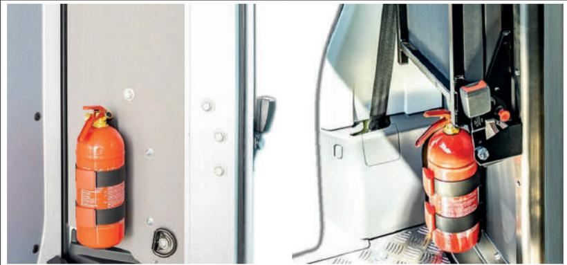
Illustration 3 : Extincteur, sur la porte coulissante du compartiment de chargement (à gauche), dans la cabine du conducteur (à droite)
