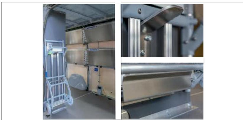
Illustration 6 : Support de chariot pour colis avec chariot (à gauche), détails (à droite)
