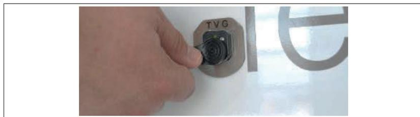
Illustration 12 : Système de verrouillage des portes du compartiment de chargement - marque TVG, ouverture avec une clé Dalles
