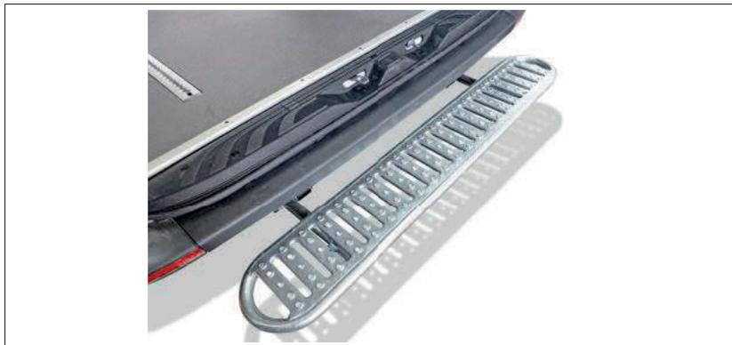
Figura 24: Pedana posteriore montata a molla
