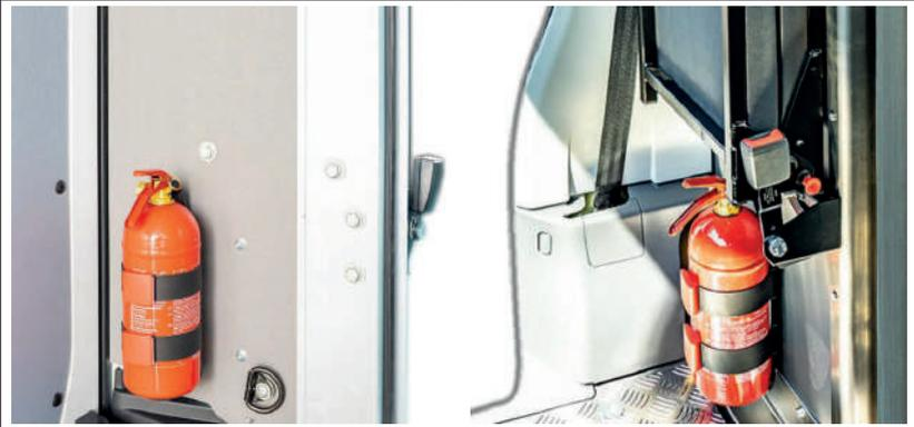
Figura 3: Estintori sulla porta scorrevole del vano di carico (sinistra), nella cabina di guida (destra)
