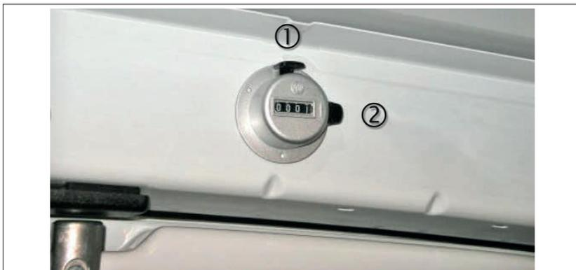
Figura 7: Contatore delle fermate
