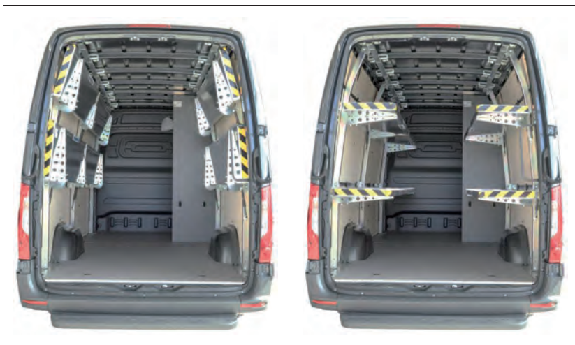
Figura 1: Sistema de estanterías plegado (izquierda), desplegado (derecha)
