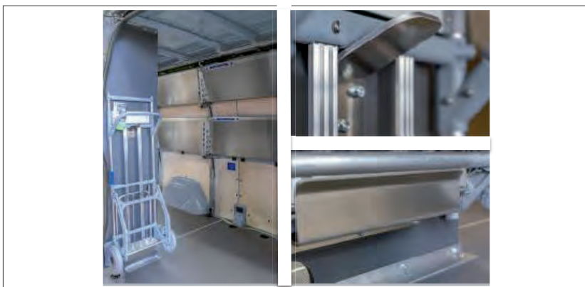
Figura 6: Soporte para carretillas de paquetes con carretilla (izquierda), detalles (derecha)
