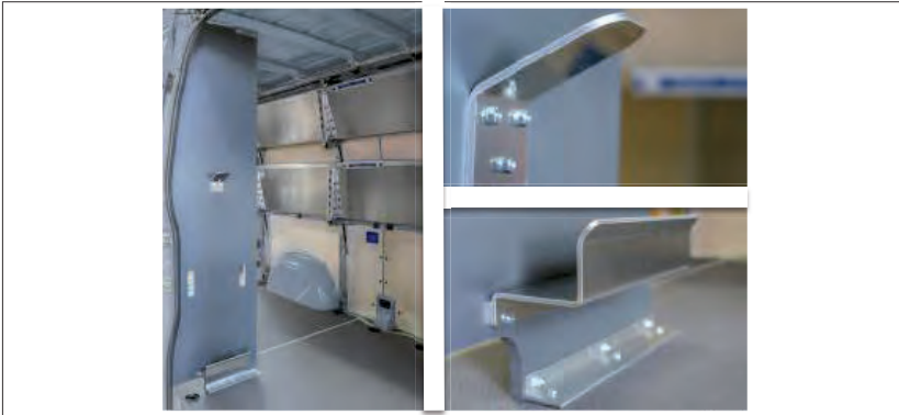
Illustration 5 : Support de chariot pour colis sans chariot (à gauche), détails (à droite)
