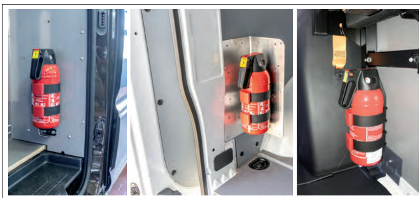
Illustration 3: Extincteur, sur la cloison du compartiment de chargement, ou derrière la porte coulissante latérale (à gauche), et dans la cabine du conducteur (à droite)
