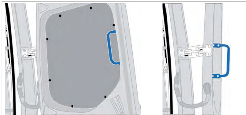
Illustration 4 : Poignée - hayon droit, semi-ouverte (à gauche), ouverte (à droite)
