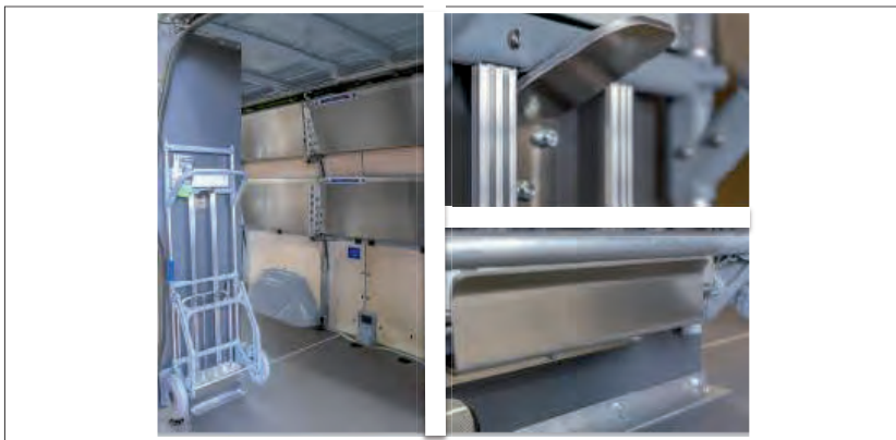
Figura 6: Sostegno per carrello portapacchi con carrello (sinistra), dettaglio (destra)
