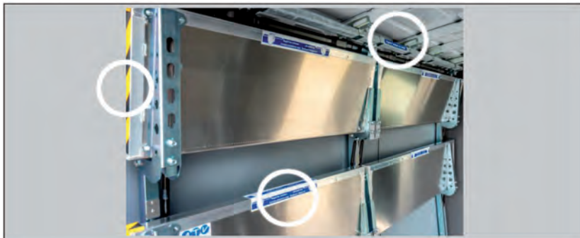
Figura 2: Scaffalatura dettaglio, posizioni dei segnali di avviso
